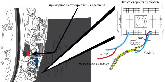
Место подключения находится с левой стороны автомобиля, в салоне, под левой кик-панелью (требуется снятие пластиковой накладки левого порожка).
